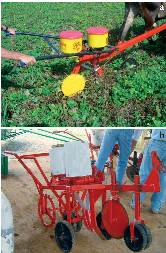
Figura 10. Semeadoras de plantio direto à tração animal modelos Werner (a) e Triton (b).
