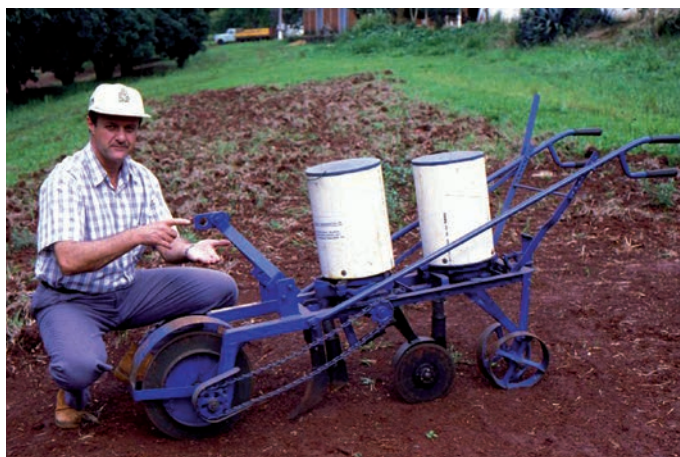
Figura 9. Primeiro modelo comercial da semeadora direta à tração animal Gralha Azul com o pesquisador responsável Dr. Ruy Casão Junior.
