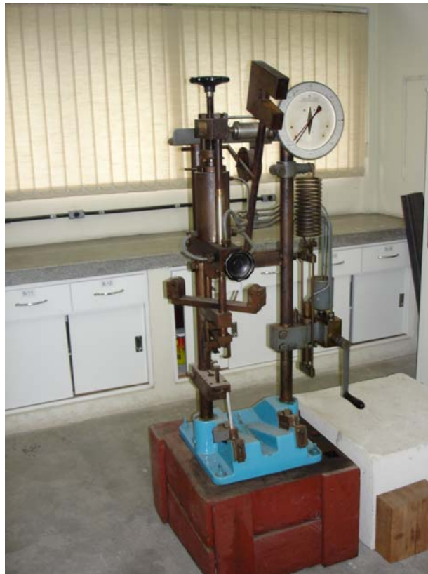
Figura 61. Equipamento adotado para a avaliação da resistência à flexão dinâmica, pelas normas DIN e AFNOR-IPT
