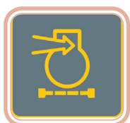
**Figura 3.10: Marcador de restrição do filtro de ar**
