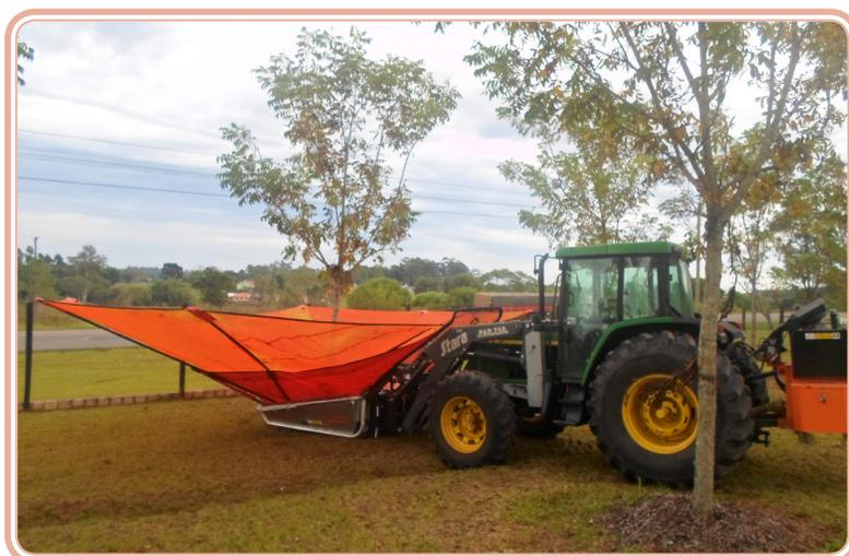
**Figura 9.3: Vibrador mecânico tratorizado com apara-frutos**
