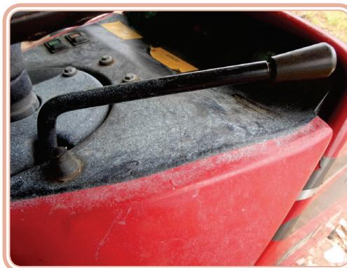
**Figura 2.14: Modelo de acelerador presente em tratores agrícolas**
