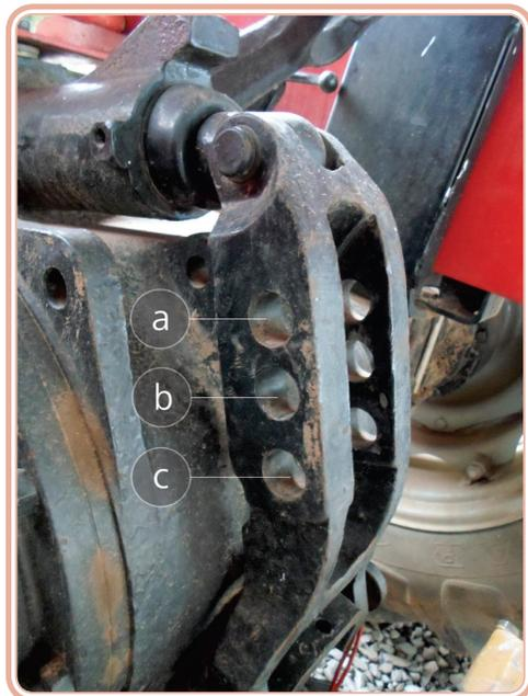
**Figura 2.6: Viga de controle com três posições para acoplamento**
