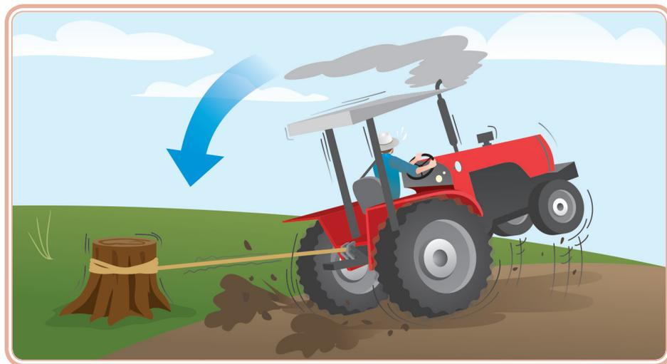
**Figura 1.6: Acoplamento da corrente na “viga C” do terceiro ponto causando o capotamento do trator**
