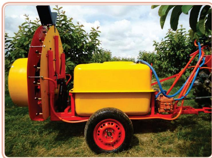
**Figura 6.16: Atomizador para fruticultura com capacidade para 500 litros**
