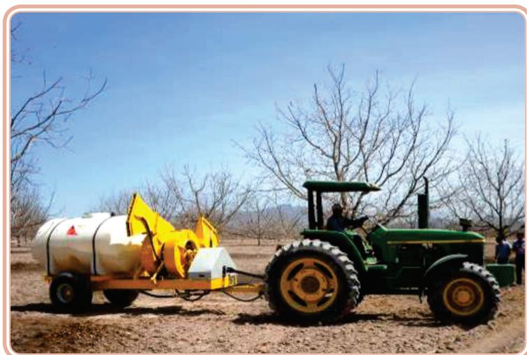
**Figura 6.14: Aplicação com atomizador tratorizado em pomar comercial de nozeira-pecã**
