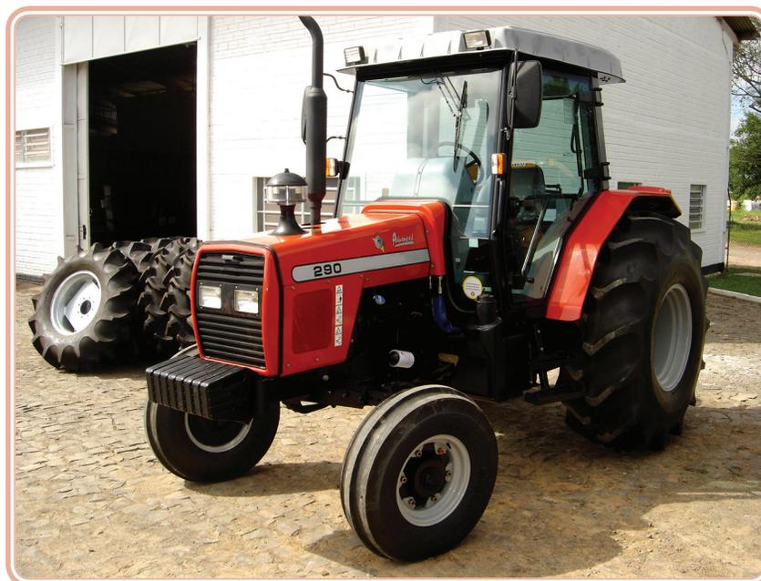
**Figura 1.1: Modelo comercial de trator 4x2**
