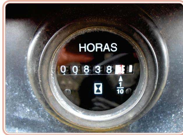
**Figura 3.2: Modelo de horímetro utilizado em tratores agrícolas**
