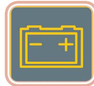
**Figura 3.7: Marcador da carga da bateria do trator**
