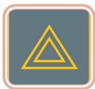
**Figura 3.15: Marcador da luz de sinalização de emergência**
