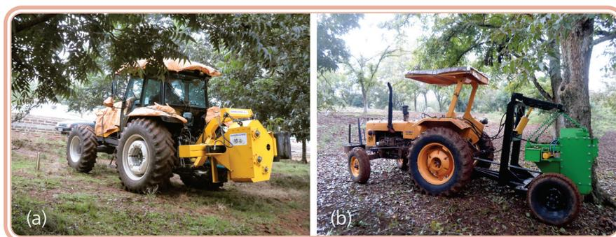
**Figura 9.1: Shacker acoplado no sistema de três pontos do trator (a) e shacker acoplado na barra de tração do trator (b)**
