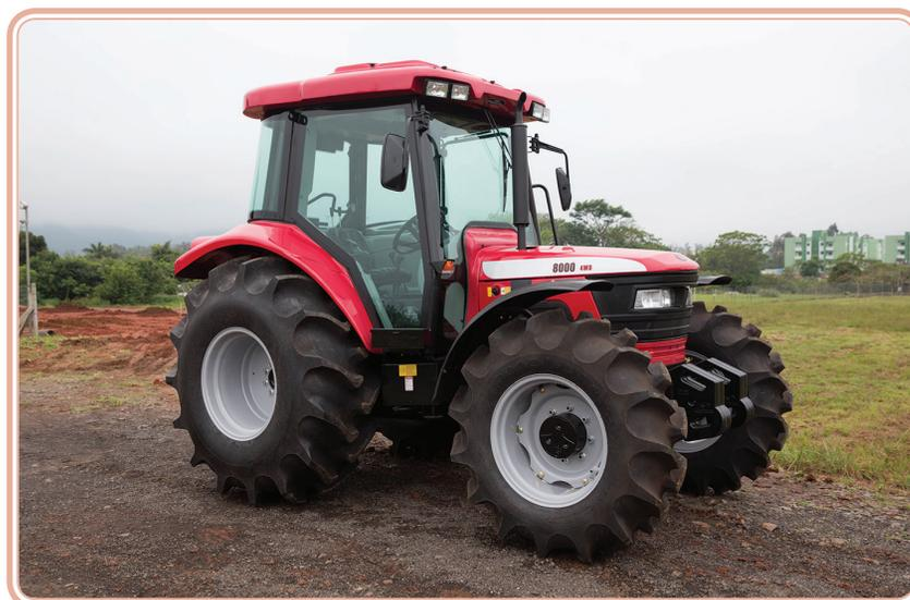
**Figura 1.2: Modelo comercial de trator 4x2 com tração dianteira auxiliar**
