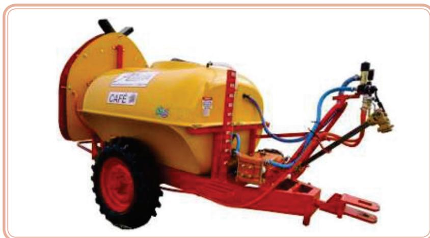
**Figura 6.17: Atomizador para fruticultura com capacidade para 1000 litros**
