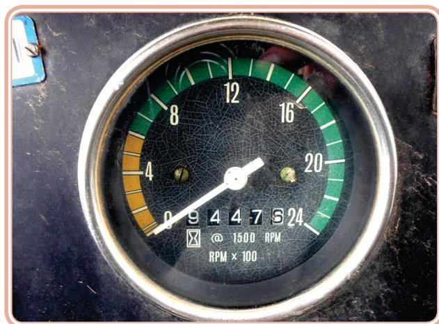
**Figura 3.4: Modelo de tacômetro de um trator agrícola**
