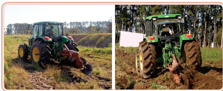
**Figura 8.1: Utilização de arado de disco para preparo primário do solo**
