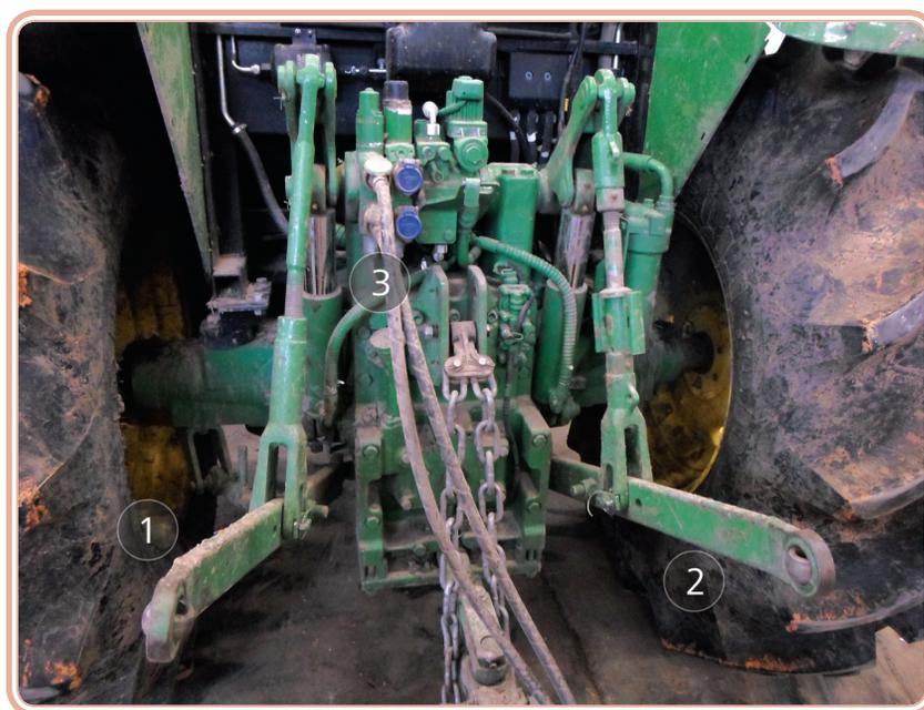
**Figura 2.5: Sistema de engate de 3 pontos (trator agrícola)**
