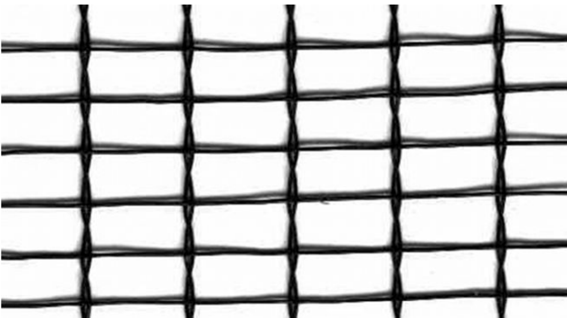
Figura 1. Detalhe da tela antigranizo, mostrando fibras de polietileno dispostas em duplo trançado na direção longitudinal (sentido vertical), e um simples trançado na direção transversal (sentido horizontal).
